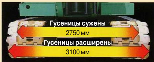
(при башмаке гусеницы 600 мм.)
